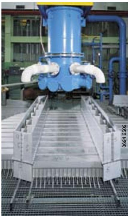
Специальный распределитель жидкости для подвижных колонн
